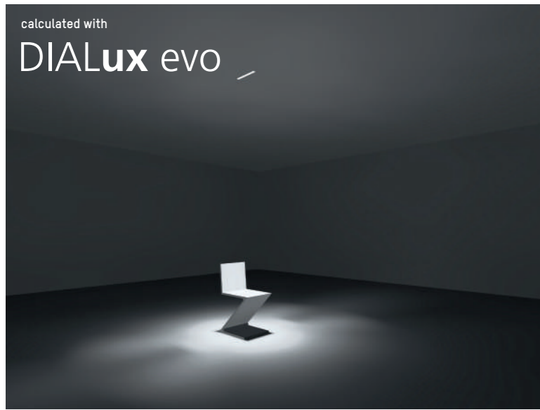
RIDE LENS · 17W · 2700K · 1400lm spot light beam 15^\circ
